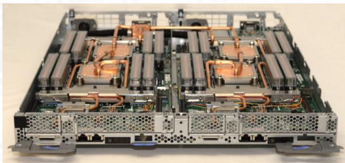
托盘中的2个nx-360M5 WCT节点
